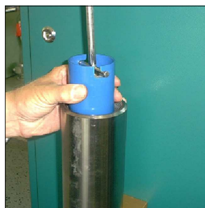
Abb. 3 - Filterpatrone aus dem Gehäuse ziehen
