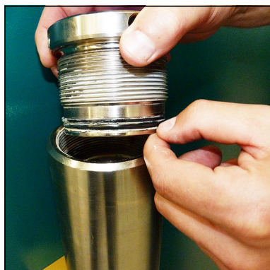
Abb. 2 - O-Ring und Stützring wechseln
