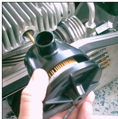
Abb. 2 - Filtergehäuse vorsichtig herausziehen
