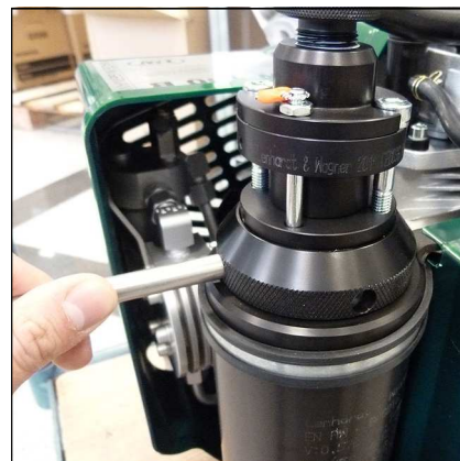
Abb. 1 - Filtergehäusedeckel mit Filterschlüssel öffnen
