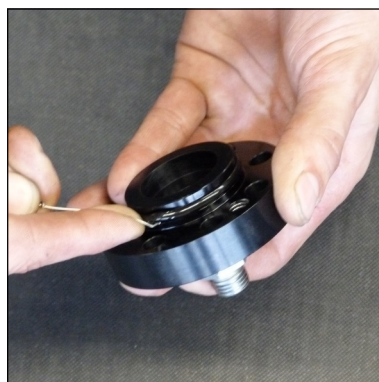
Abb. 4 - O-Ring wechseln (Deckel Kondensat-Stopp-Ventil)
