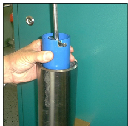
Abb. 3 - Filterpatrone aus dem Gehäuse ziehen
