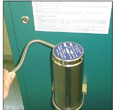
Abb. 1 - Abschrauben des Filtergehäuse-Deckels
