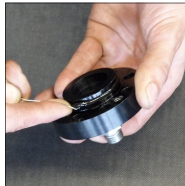
Abb. 4 - O-Ring wechseln (Deckel Kondensat-Stopp-Ventil)
