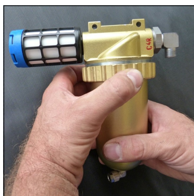
Fig. 1 - Loosen ring nut
