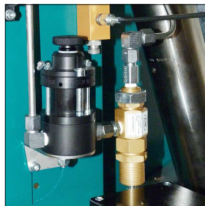
Abb. links Sicherheitsventil: 225 bar, rechts Druckminderer: 330 / 225 bar
