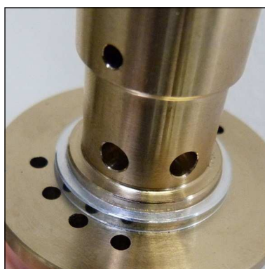
Abb. 4 - Auf korrekte Einbauposition des oberen Ventildichtrings achten
