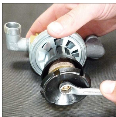
Abb. 2 - Mutter am Oberteil lösen
