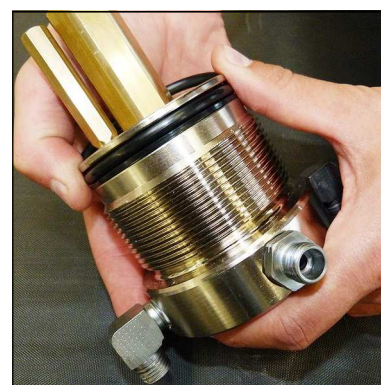
Abb. 4 - O-Ring und Stützring wechseln
