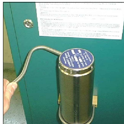
Abb. 1 - Abschrauben des Filtergehäuse-Deckels
