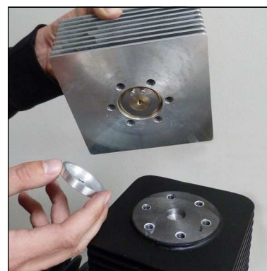
Abb. 2 - Untere Ventildichtung entfernen
