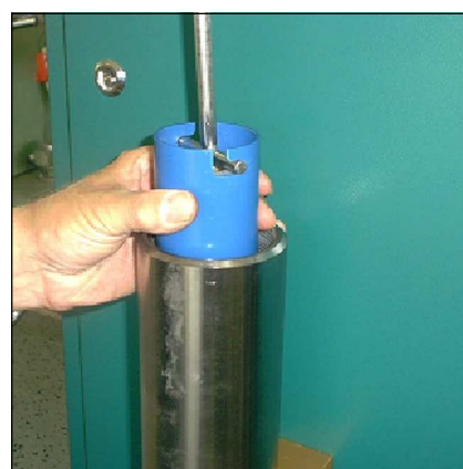
Abb. 3 - Filterpatrone aus dem Gehäuse ziehen
