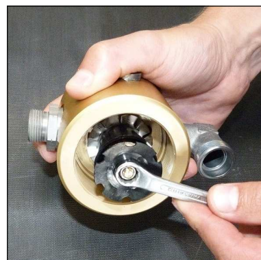
Abb. 2 - Mutter am Oberteil lösen
