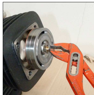
Abb. 2 - Saug- / Druckventil herausziehen
