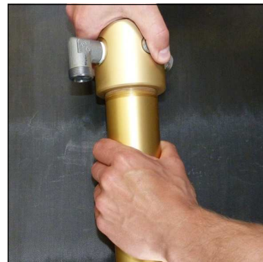
Abb. 1 - Oberteil abschrauben und abnehmen
