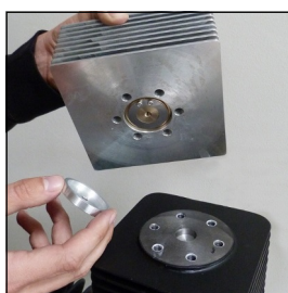
Abb. 2 Untere Ventildichtung entfernen
