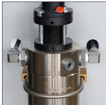
Abb. 1 - Rohrleitungen und Muttern lösen
