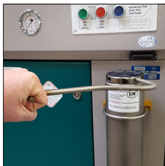
Abb. 2 - Abschrauben des Filtergehäuse-Deckels
