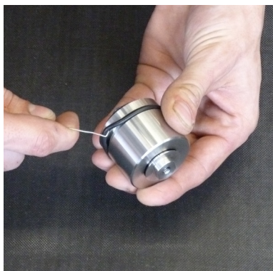
Abb. 4 - O-Ring wechseln am Kondensat-Stopp-Ventil
