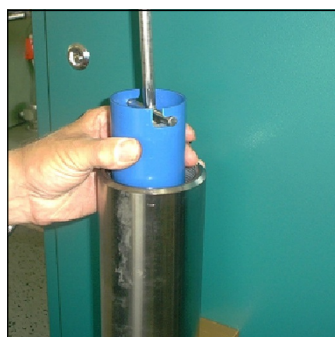
Abb. 4 - Filterpatrone aus dem Gehäuse entnehmen
