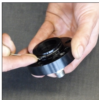
Abb. 4 - O-Ring wechseln (Deckel Kondensat-Stopp-Ventil)
