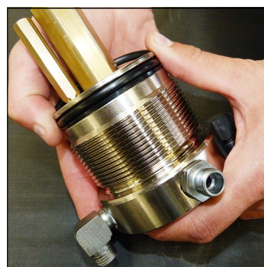
Abb. 4 - O-Ring und Stützring wechseln
