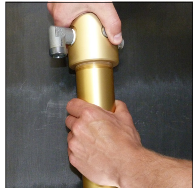
Abb. 1 - Oberteil abschrauben und abnehmen
