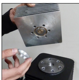
Abb. 2 Untere Ventildichtung entfernen
