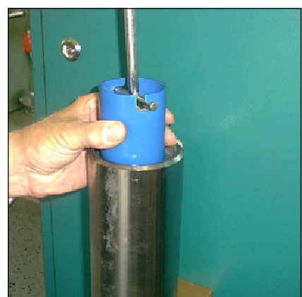
Abb. 3 - Filterpatrone aus dem Gehäuse ziehen
