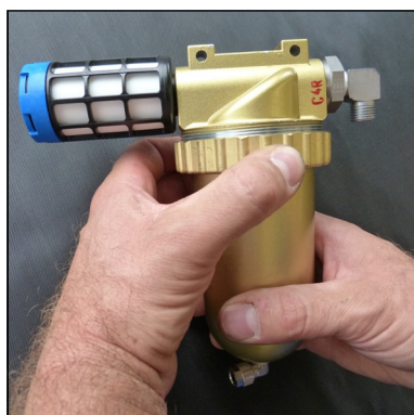
Fig. 1 - Loosen ring nut
