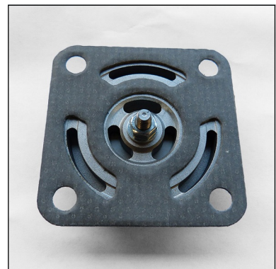
Abb. 4 - Auf korrekte Platzierung der Papierdichtung achten!
