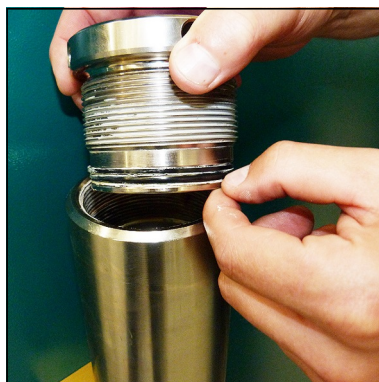
Abb. 2 - O-Ring und Stützring wechseln
